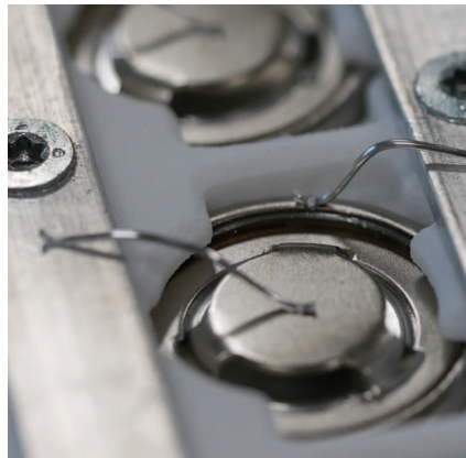
Bild 5: Batteriepack mit Smart Welding (links) und Drahtbonds (rechts)
