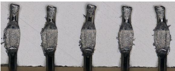
**Bild 9** Wedges gebondet auf Überhang (Bondkraft: 28 cN; mittlere Deformation: 44,3 µm)
