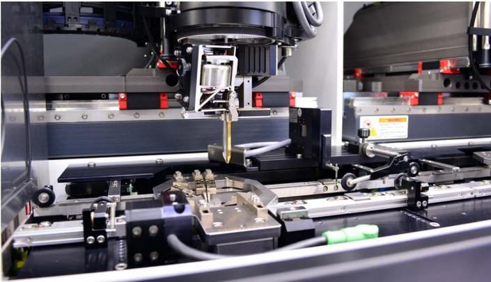
Dickdraht-Bondkopf mit Bondkraft-Kalibrierung und Pullmodul
